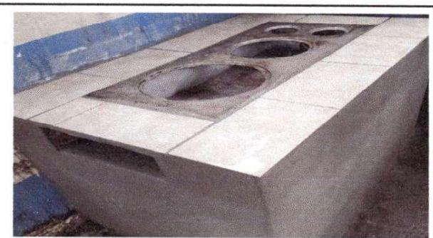
Foto 6: Sustitución de estufa rural (completa) incluye chimenea y plancha de metal
